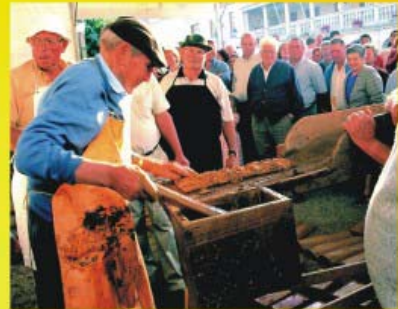
2.- O OFICIAL -co barro xa depositado na GRADILLA - dispónse a coller o RASEIRO para eliminar o material sobrante ( CAGHALLAS ).
